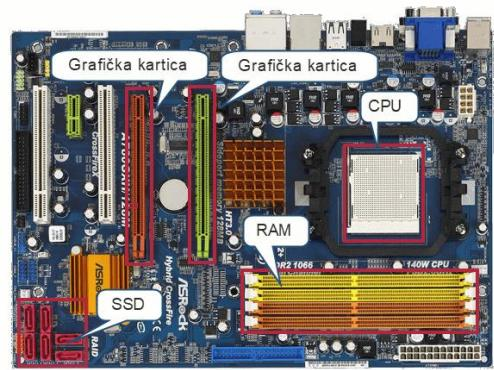
RAM (Random Access Memory) – središnji spremnik u koji se privremeno spremaju podatci (kada isključimo računalo podatci se brišu)
