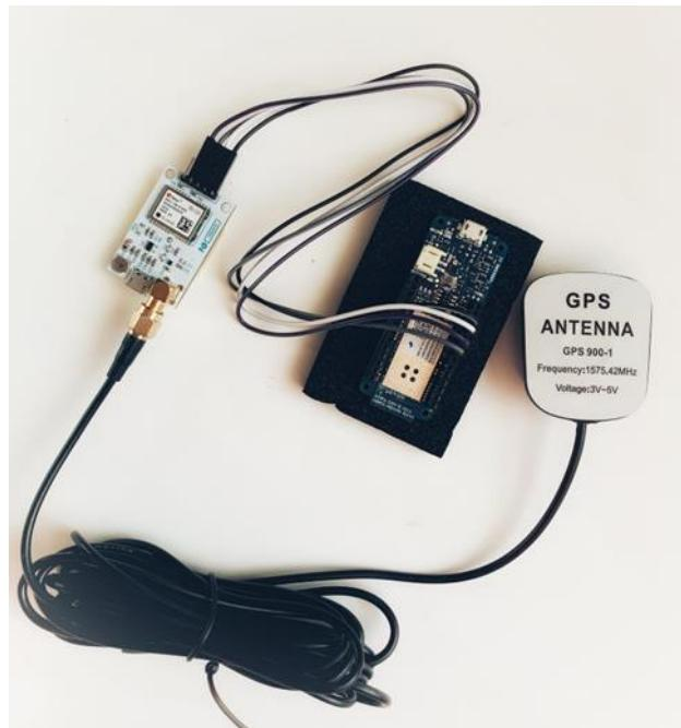
Slika 27Arduino (MKR1000), GPS modul (U-BLOX NEO -7M) i eksterna GPS antena (GPS 900-1)
